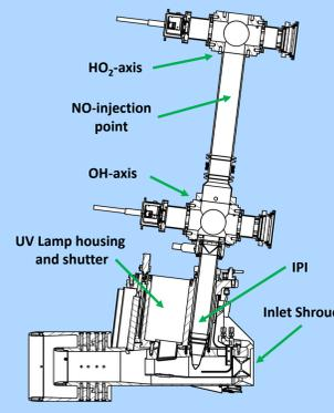
Fig 2a : Drawing of the Inlet Shroud and HORUS-Instrument
