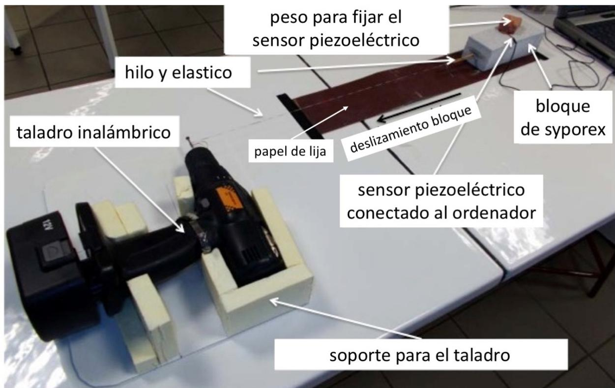
Fig. 10 – Configuración del experimento stick-slip.
