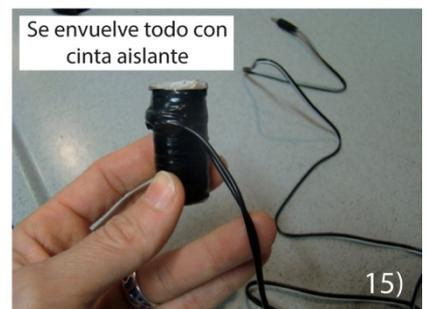
Fig. A1.2\_1 - Cómo se construye la bobina del sismómetro. Hace clic [aquí](#) para ver el video de cómo enrollar el hilo de cobre.
