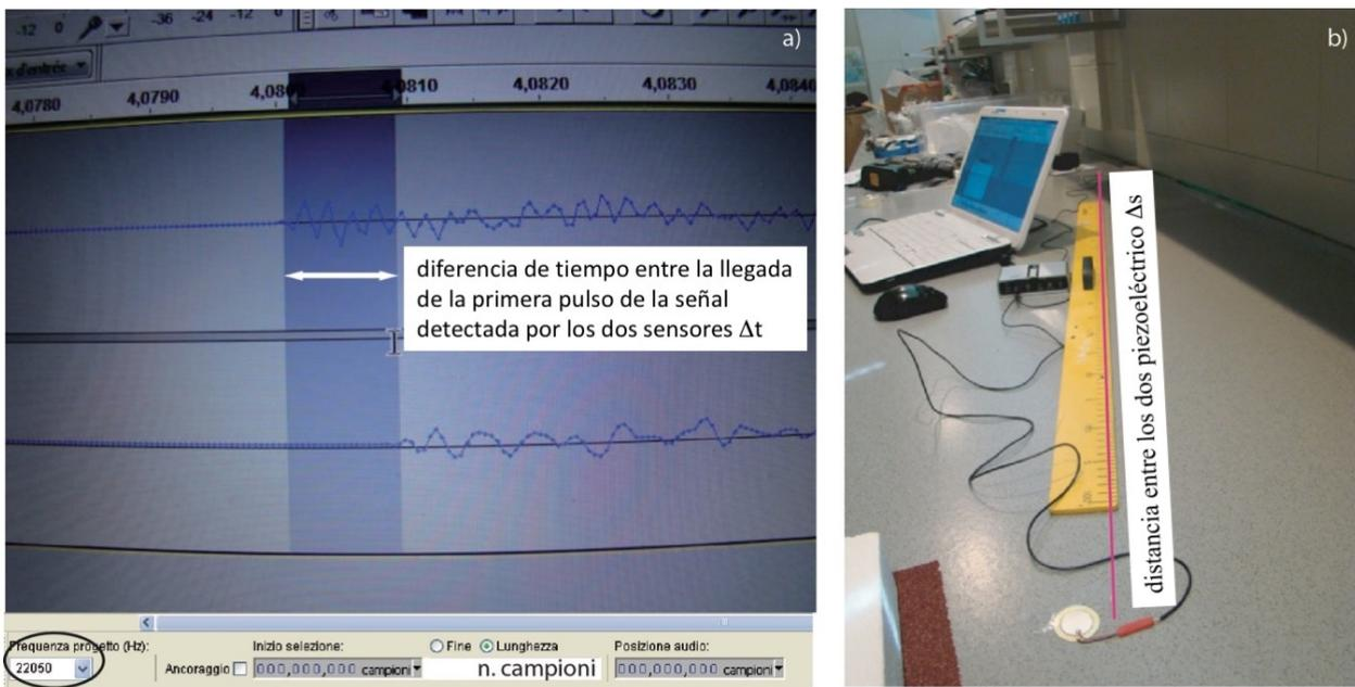
*Fig. 9 – a) Sismogramas producidos por la ruptura de una lámina de lasaña. Los dos sensores piezoeléctricos registran la llegada de las ondas. Se puede medir la diferencia de tiempo entre las dos llegadas de las ondas desde los sensores piezoeléctricos (el superior más cerca del hipocentro). b) Si se conoce la diferencia  $t$  y la distancia entre los dos sensores piezoeléctricos es posible calcular la velocidad de propagación de las ondas en el medio.*
