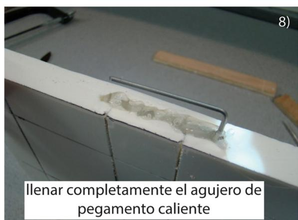
Fig. A1.2\_9. Cómo hacer ganchos y colocarlos en las bases de poliestireno extruido.
